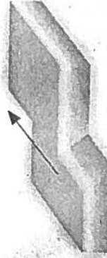
Falla de desgarre
